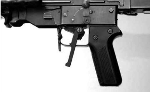
Bild 17: Winterabzug für Linksschützen zu Stgw 57
