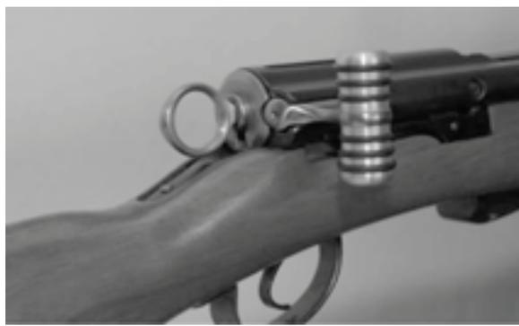
Figure 22: Poignée de verrou anatomique pour mousqueton et fusil
