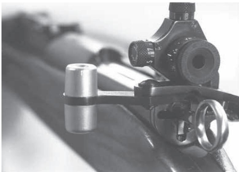
Figure 20: Verrou à gauche pour mousqueton 31
